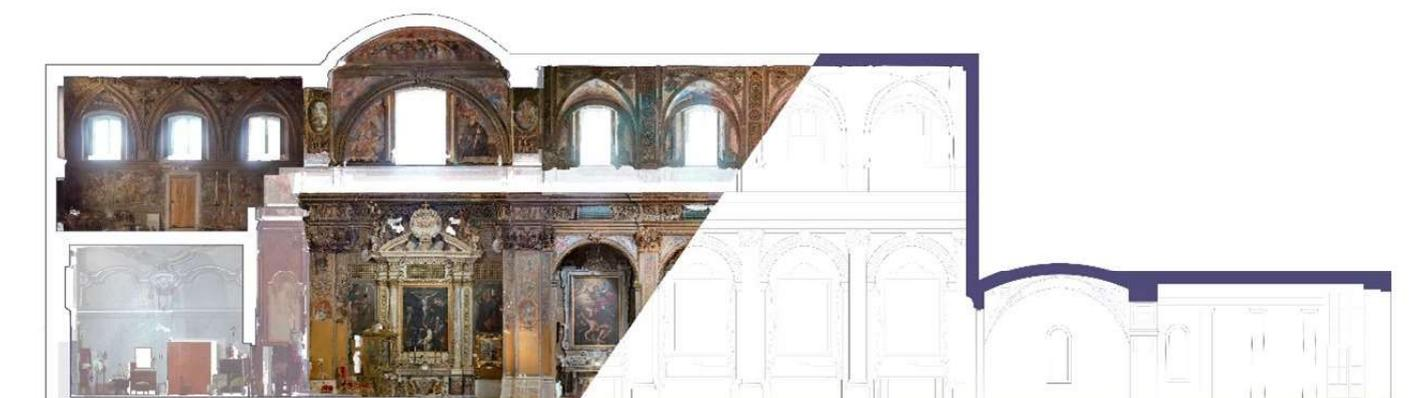
Figura 3. Alzado interior de la iglesia de San Giorgio de Salerno. Restitución gráfica realizada a partir del levantamiento fotogramétrico. Producción de los autores.
