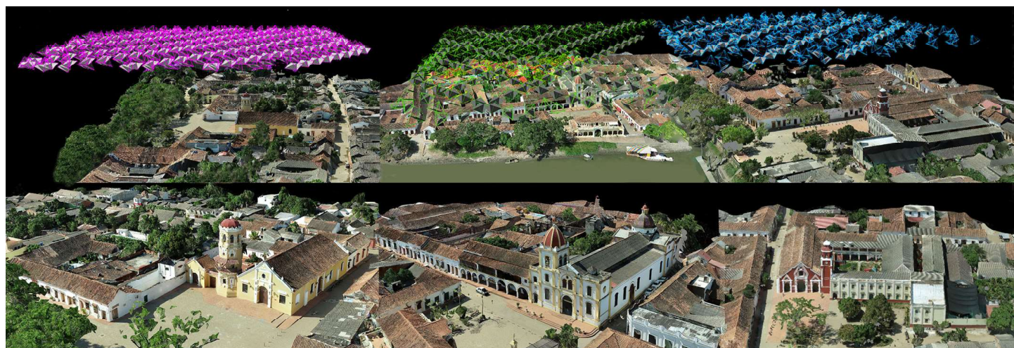
Figura 4. Levantamiento fotogramétrico de los UAV. La fase de adquisición se llevó a cabo mediante la planificación de tres planes de vuelo estructurados sobre la base de una cuadrícula básica (75x85m) subdividida por un esquema de diagonales utilizado para garantizar la superposición entre planos contiguos (tasa de superposición lateral 45%; tasa de superposición delantera 50%) tiempo estimado de adquisición 17 min.
