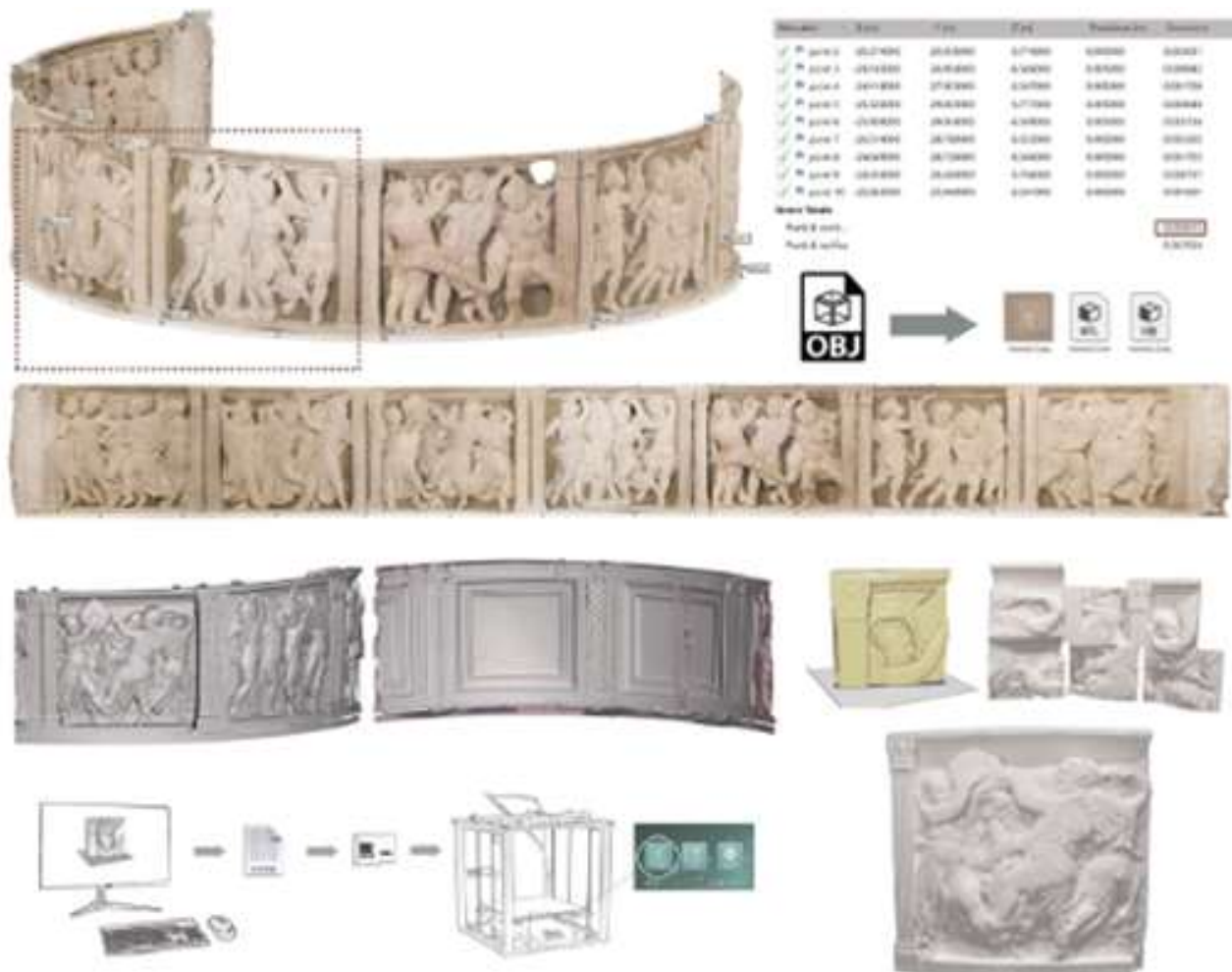
Figura 5. Arriba: reconstrucción digital de las tejas mediante base fotogramétrica. En el centro: fotoplano ortorrectificado siguiendo la proyección de la superficie cilíndrica sobre el plano. Abajo: procesamiento del modelo en el software mezclador AutoDesk Mesh e imágenes de la impresión 3D a escala 1:1 de un mosaico.
