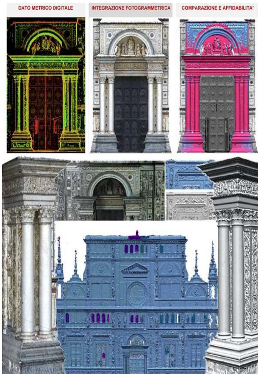
Figura 4. Arriba, comparación entre la base de datos derivada de las adquisiciones láser y la base de datos fotogramétrica. Abajo, los resultados de la postproducción de las nubes de puntos, a partir de la cual fue posible obtener modelos 3D altamente fiables.
