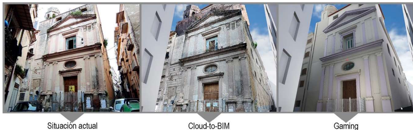
Figura 2. Resultados gráficos de las fases de elaboración del modelo de juego siguiendo el enfoque Cloud to BIM.
