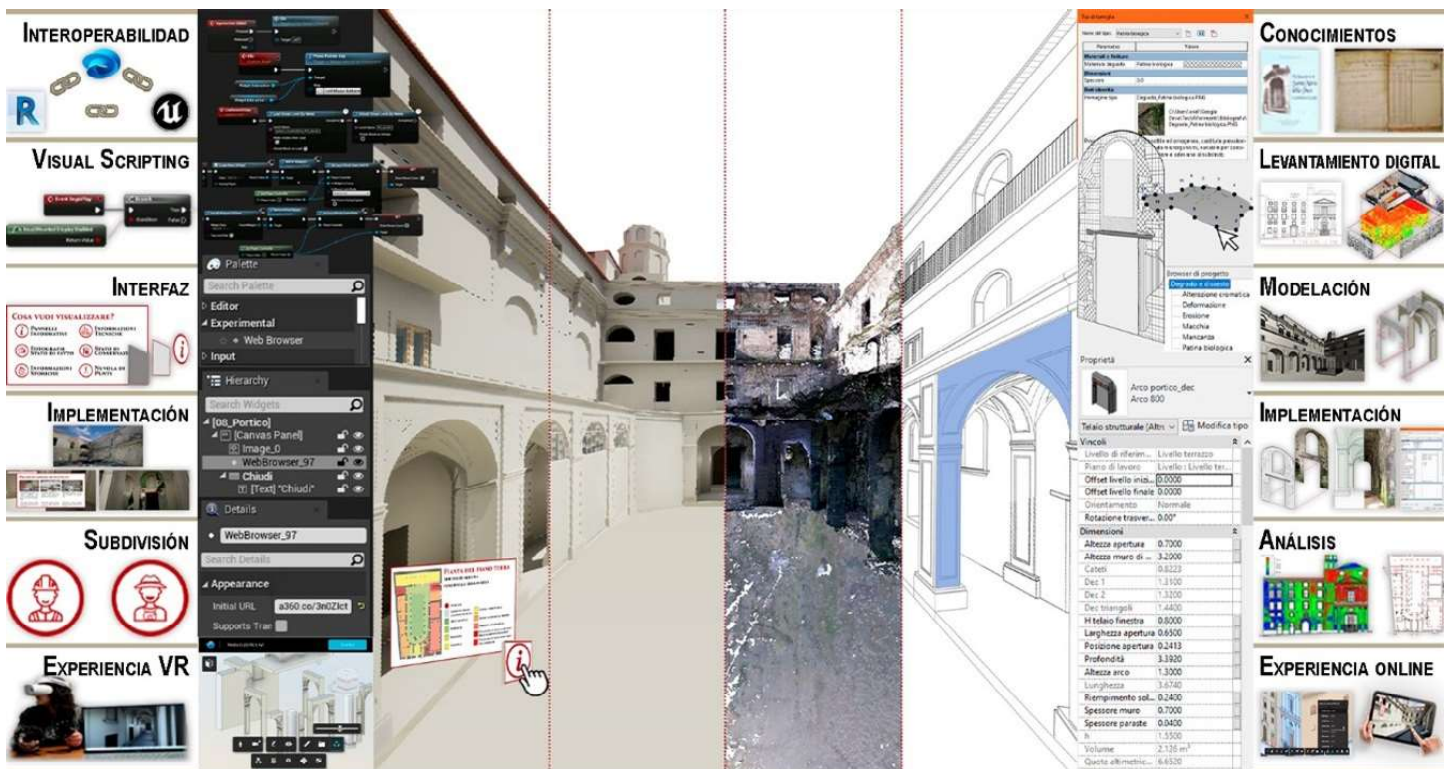
Figura 3 Resumen del proceso de documentación, análisis, reconstrucción y comunicación entre la parametrización digital y la estructuración de un proceso de uso virtual a través de widgets elaborados en blueprints de scripting visual.
